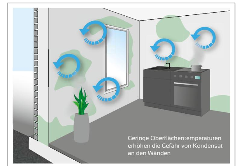
Geringe Oberflächentemperaturen erhöhen die Gefahr von Kondensat an den Wänden
