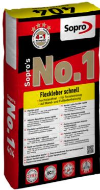
Zementärer, schnell erhärtender Flexkleber, C2 FTE S1 nach DIN EN 12004, mit hoher Kunststoffvergütung zum Ansetzen und Verlegen keramischer Fliesen und Platten sowie dunkler, verformungsstabiler Naturwerksteine. Geeignet auf Wand- und Fußbodenheizungen und Verbundabdichtungen sowie für Feinsteinzeug, Steingut und Steinzeug. Hohe Ergiebigkeit und beste Verarbeitungseigenschaften. Mit der bekannten 4-in-1-Rezeptur.
