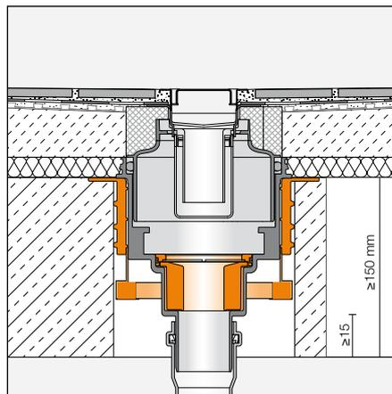
Durchgangsdichtung KD ZBS mit Brandschutzfunktion
