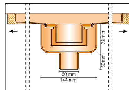
Längsschnitt Wand- /Mitteleinbau
