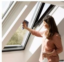
Um die Außenscheibe von innen zu reinigen, drehen Sie den Griff am Flügel-Unterteil in die senkrechte Position und ziehen Sie die Griffleiste an der Lüftungsklappe. Drehen Sie den Fensterflügel vollständig und sichern Sie ihn in der Reinigungsposition, indem Sie die Putzriegel in die Putzriegelbuchsen schieben.
