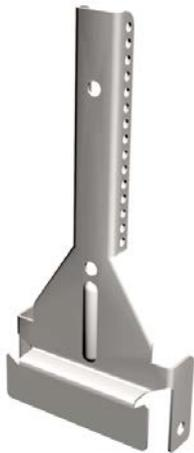
Rigips Nonius Unterteile CD 400 C3 – hoch dienen zur Ausbildung von Abhängungen in Gipsplattensystemen im Deckenbereich von Feucht- und Nassräumen. Das Rigips Nonius Unterteil wird mit dem Nonius Oberteil durch zwei Rigips Nonius Sicherungsklammern verbunden. Das Nonius Unterteil CD 400 C3 – hoch ermöglicht die Aufnahme des Rigips C-Deckenprofils als Grundprofil der Deckenkonstruktion und benötigt eine Verschraubung mit der Rigips Spezial-Bauschraube 3,5 x 10 mm.
