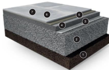
Die gesamte Konstruktion (inklusive der Belagsoberfläche) ist mit einem Gefälle von 1,5 bis 2 % Gefälle anzulegen.
