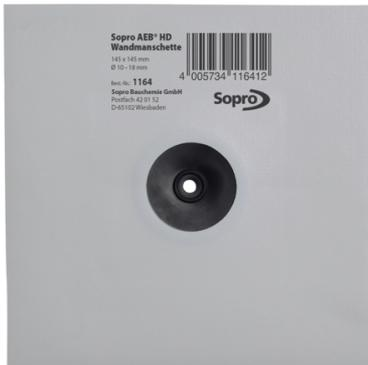
Innovative, chemisch- und mechanisch hoch beanspruchbare Premium-Dichtmanschetten mit flexibler Dehnzone ohne äußere Vliesbeschichtung, zum sicheren Abdichten von Rohrdurchführungen in Kombination mit Sopro AEB® Abdichtungs- und Entkopplungsbahn HD unterhalb keramischer Fliesen und Platten sowie von Naturwerksteinfliesen.
