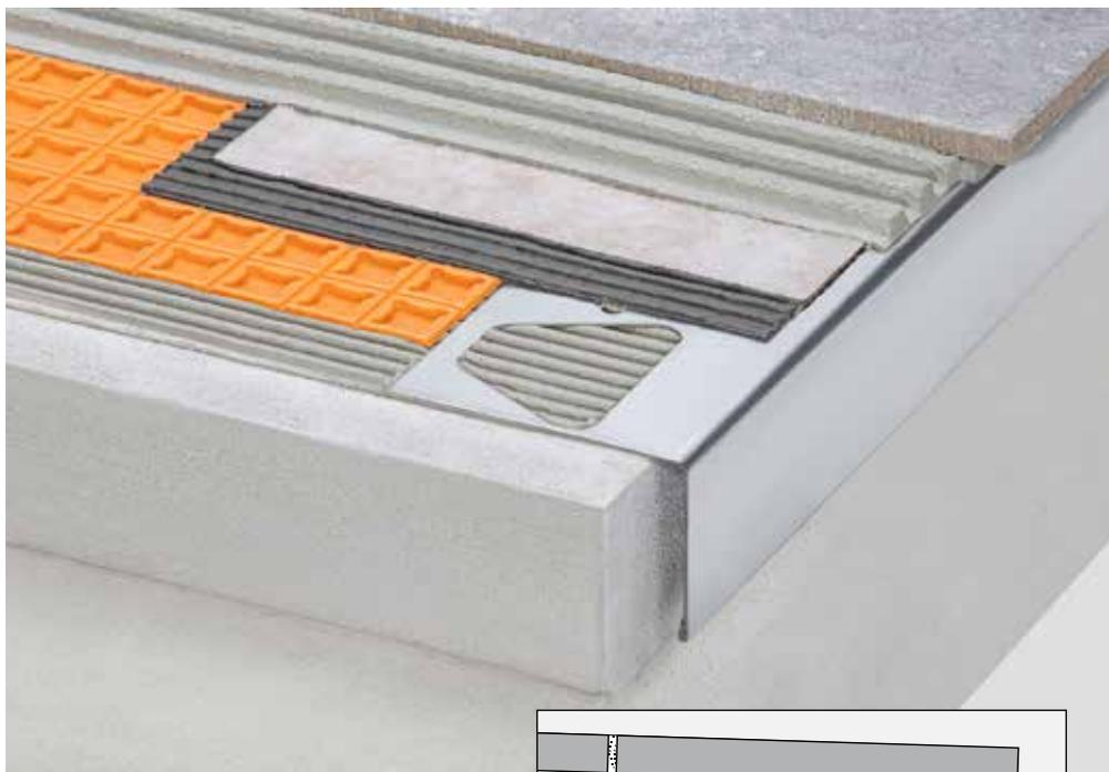
Schlüter-BARA-RW-E wird aus Edelstahl-Blechbändern, V2A (Werkstoff 1.4301) geformt. Edelstahl ist besonders für Anwendungen geeignet, die neben einer hohen mechanischen Belastbarkeit eine Beständigkeit gegenüber Chemikalienbeanspruchungen, z. B. durch saure oder alkalische Medien, Reinigungsmittel erfordern. Auch Edelstahl ist nicht gegen alle chemischen Angriffe beständig.
